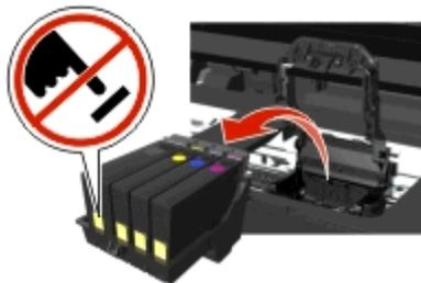
3 用干净且不掉毛的布清理打印头接触点和打印头拖车内的接触点。
