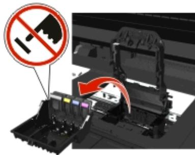
5 装入支持的打印头，然后关闭保护盖，直到其**咔嚓**一声，卡入到位。
