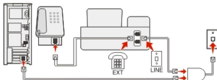
数字用户线路(DSL)将您的常规电话线分成两个通道：语音和互联网。电话和传真信号通过语音通道传输，而互联网信号通过另一个通道传输。在这种情况下，您可以使用同一条线路实现模拟语音电话（包括传真）和数字互联网连接。
