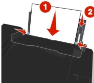
**注意：**请不要用力将纸张塞入打印机内。纸张应该平整地放置在纸张支架的表面上，并且纸张的边缘应该紧靠两边的进纸导轨。
